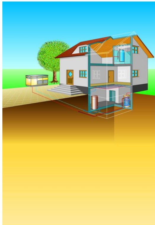
Abbildung 27: Glashausgrafik - Wärmebereitung mit Luft/Wasser-Wärmepumpe
